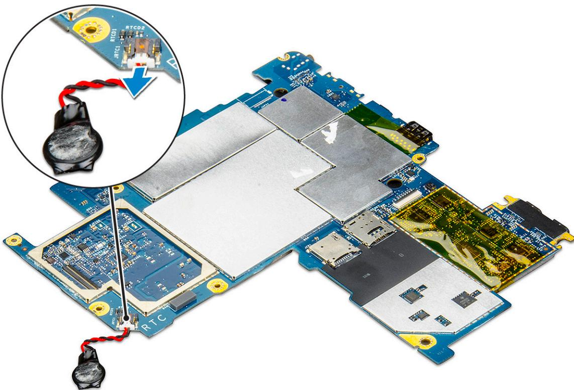
***(i) CATATAN:*** Jika Anda dapat dengan mudah melepaskan kabel baterai sel koin dari bawah konektor pada board sistem, Anda tidak perlu melepaskan board sistem untuk melepaskan baterai sel koin.
